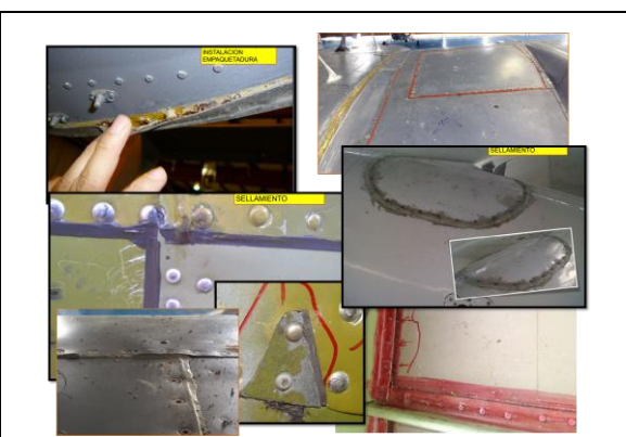
Figura 6. Deficiencias en uso y aplicación de sellantes aeronáuticos. Mala aplicación o selección
