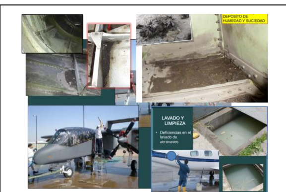
Figura 4. Deficiencias en la limpieza de las aeronaves. Acumulación de suciedad, obstrucción
