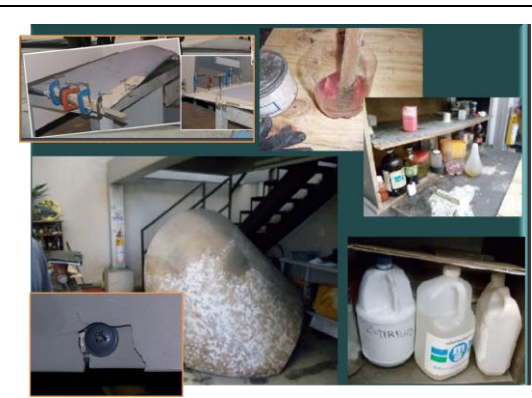
Figura 10. Deficiencias en el mantenimiento y reparación de estructura compuesta
