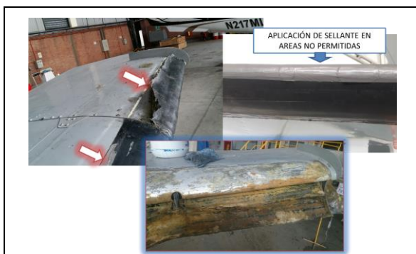
Figura 11. Deficiencias en el mantenimiento de botas deshieladoras, utilización de productos y métodos de reparación no autorizados
