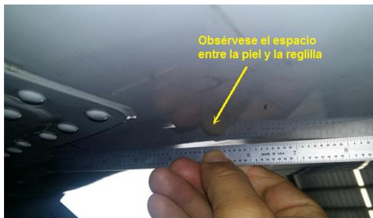
Fotografía 1, Deformación de la piel
